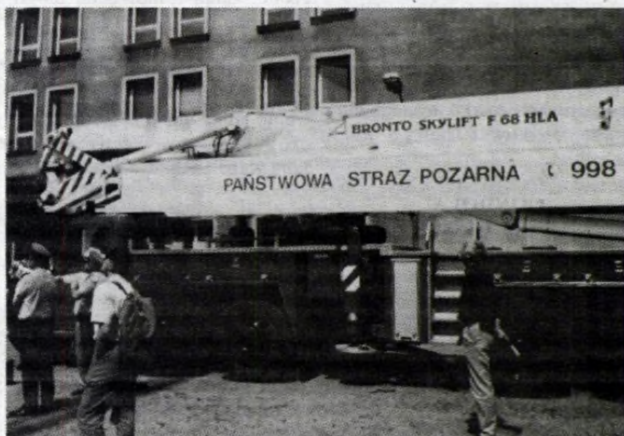
Samochód z podnośnikiem hydraulicznym o wysokości ramienia 68 m (20 pięter) wejdzie do akcji dopiero za chwilę... Konstrukcja samochodu jest złożeniem podwozia produkcji niemieckiego „Mercedesa” i podnośnika rodem z Finlandii.
