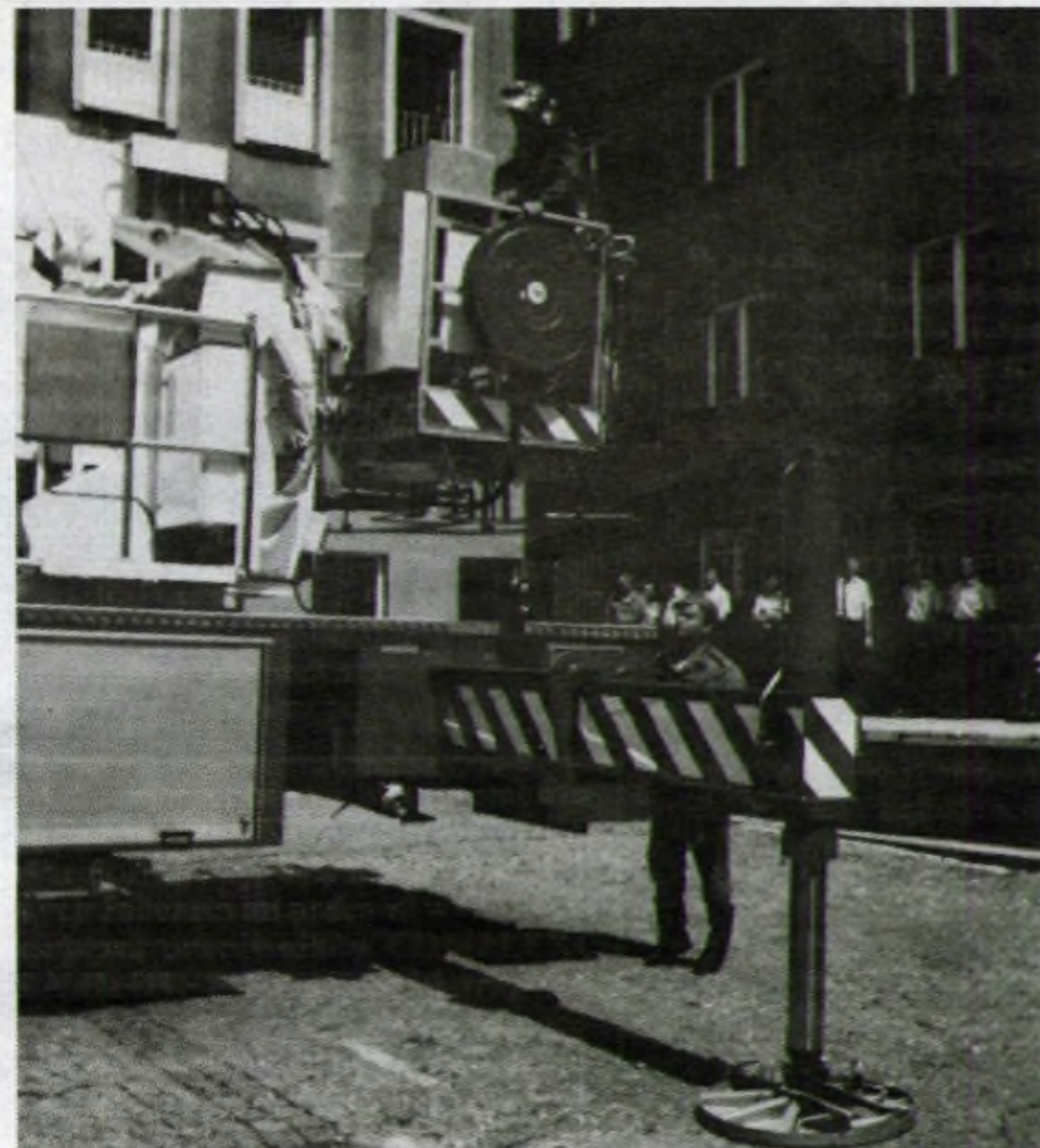
Po rozstawieniu potężnych podpór stabilizujących samochód, kapitan Krzysztof Mendak jeszcze sprawdzi wskazania wiatromierza...
