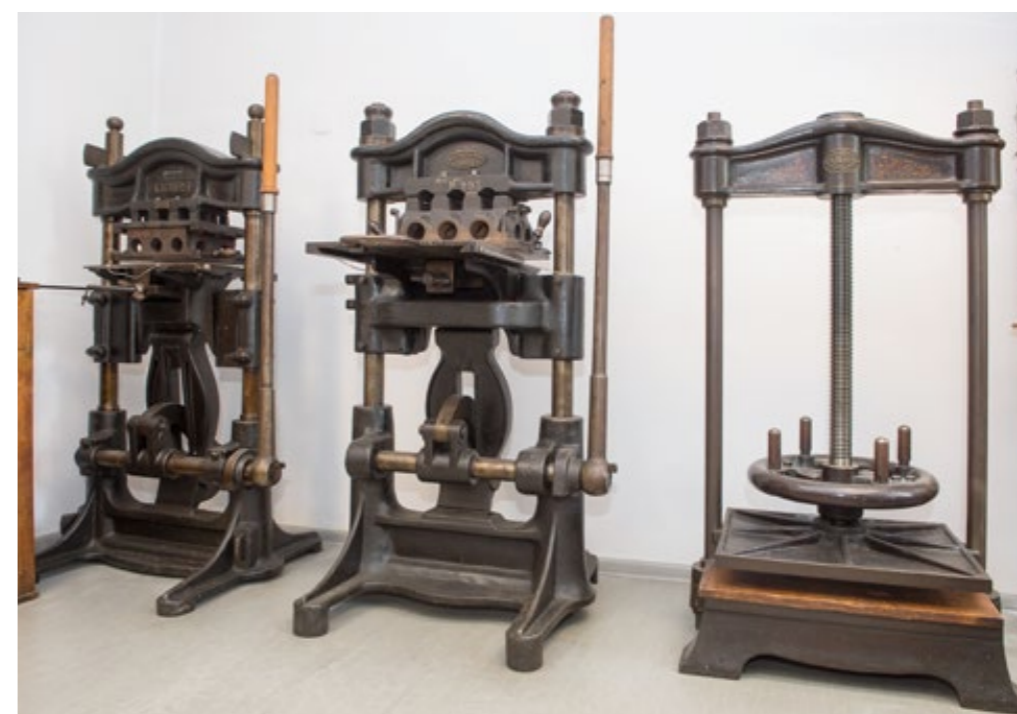
Tygły do złączenia na gorąco i prasa introligatorska
